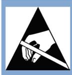
**AVERTISSEMENT :** Contient des pièces et des assemblages susceptibles d'être endommagés par les décharges électrostatiques (ESD). Cet appareil est sensible aux décharges électrostatiques et doit être installé par du personnel spécialisé dans la sensibilisation aux décharges électrostatiques. Les procédures de manutention correctes comprennent le port de bracelets antistatiques.
