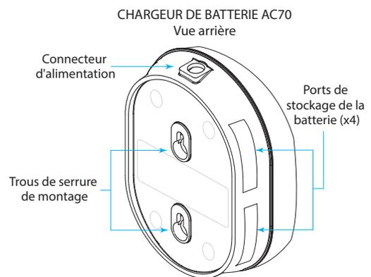
**Remarque :** Les ports de stockage ne permettent pas de charger les batteries
