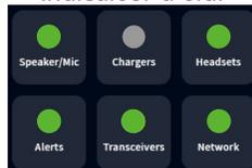
**Remarque :** L'AC70 doit être à proximité physique (< 3 m (10 pieds)) de la station de base si vous souhaitez surveiller l'état de la batterie par le biais de l'écran ACCUEIL de la station de base. Lorsque vous êtes à portée, l'indicateur des chargeurs sur l'écran ACCUEIL passe de ● à ● (gris à vert). Une fois qu'il est vert, appuyer sur **Chargers** pour afficher l'état de la batterie, voir Schéma 5.3.
