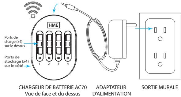
**Remarque :** N'utilisez que l'adaptateur électrique approuvé par HME fourni.
